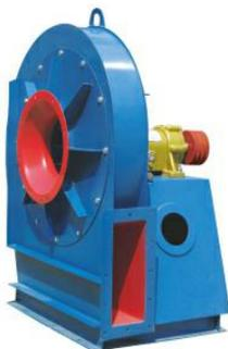
Y6-30(c)型高压锅炉引风机具有压力效率高, 噪声低等特点, 是为专业为燃烧质量差别较大, 产生抽风力不足而影响锅炉正常生产而设计的风机, 使用时其介质温度 $\leq 250^{\circ}\text{C}$ , 无腐蚀性及粘性物质的气体排送。输送气体温度超过 $250^{\circ}\text{C}$ 的可提供其性能尺寸相同的316不锈钢材质的耐高温风机, 用于输送腐蚀性气体或温度 $\leq 500^{\circ}\text{C}$ 。
